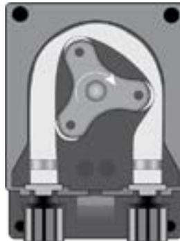
Positionieren Sie die Rolle wie in der Abbildung gezeigt und drehen Sie sie in Richtung des kreisförmigen Pfeils.
