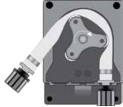
Hängen Sie das linke Verbindungsstück vollständig aus, indem Sie es nach außen halten, und drehen Sie dann die Rolle in Richtung des kreisförmigen Pfeils, um den Schlauch aus dem rechten Verbindungsstück zu lösen.
