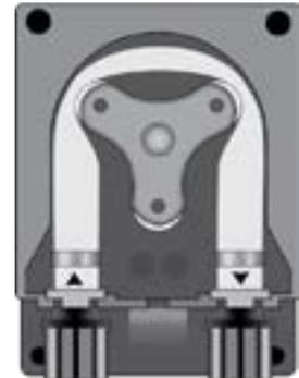
Schließen Sie den Pumpendeckel und drücken Sie fest auf seine Oberfläche, damit er einrastet.
