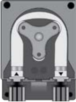
Öffnen Sie den Pumpendeckel und lösen Sie den Schlauch, indem Sie den linken Anschluss nach oben ziehen.
