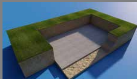
Bild 2b: Aushub ohne Schacht/Ausgleichsbehälter - einzelne Schichten
