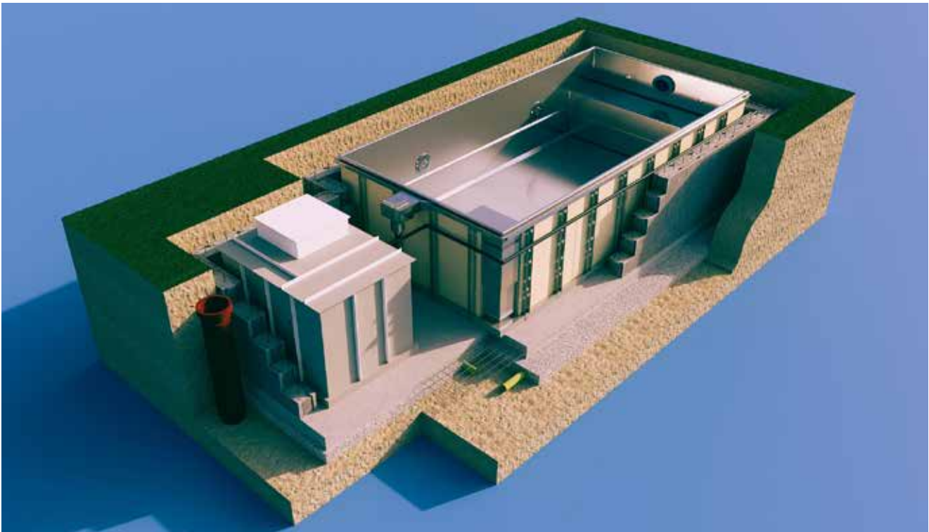
Bild 1: Pool mit Technischacht - Gesamtblick
