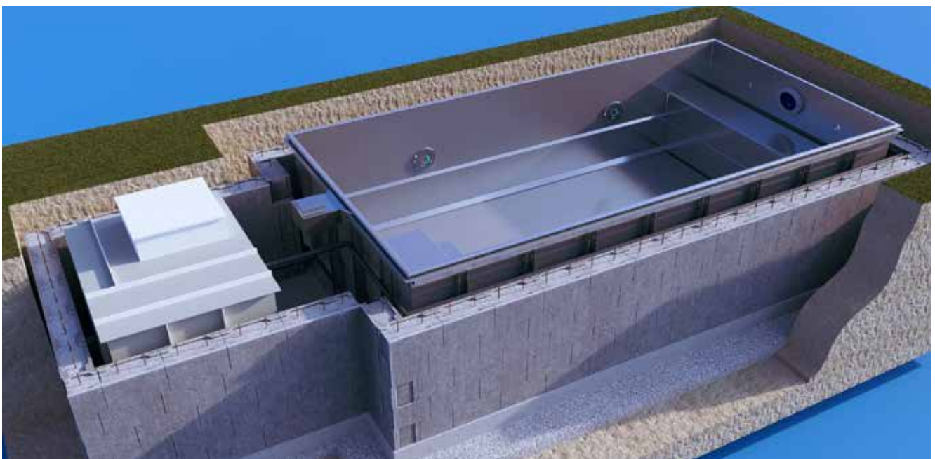
Bild 10: Schalung - Aushub mit dem Schacht/Ausgleichsbehälter
