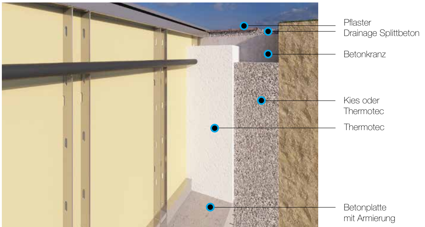
Bild 17: Hinterfüllung der Baugrube mit isolierendem Thermotec-Leichtbeton
