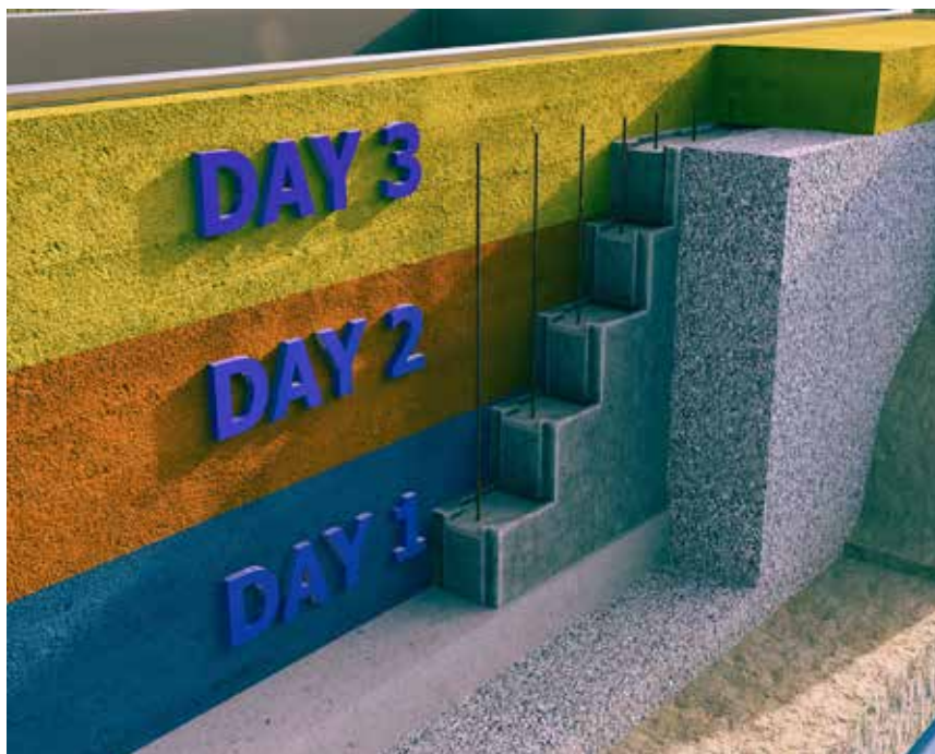
Bild 15: Pool Hinterfüllung mit trockenem Beton in 3 Tagen
