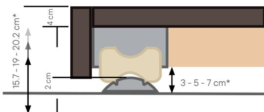
\* Höhenverstellbar mit 3 definierten Stufen
